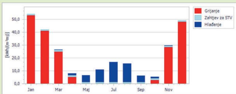
Slika 6 Primarna energija [ $\text{kWh}/(\text{m}^2 \cdot \text{mjesecno})$ ]
