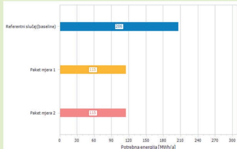
Slika 9 Potrebna energija: sadašnje stanje, stanje nakon primjene paket EE mjera 1 i nakon primjene paket EE mjera 2.
